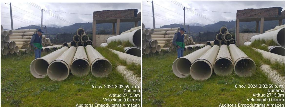
Como es evidente esta tubería se encuentra totalmente expuesta a condiciones climáticas, condición que contraviene lo señalado por las empresas fabricantes en los manuales técnicos en cuanto a los requerimientos de almacenamiento para estos bienes, como se indica:
